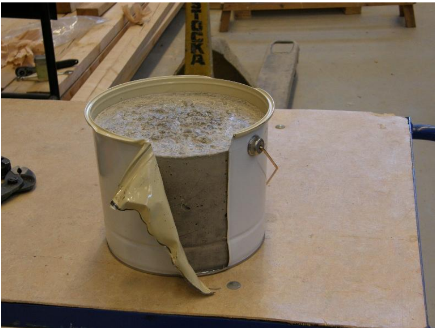
Figur 2.3 Demontering av prov från form sker genom att mantel delas vid befintlig skarv med hjälp av tång.
