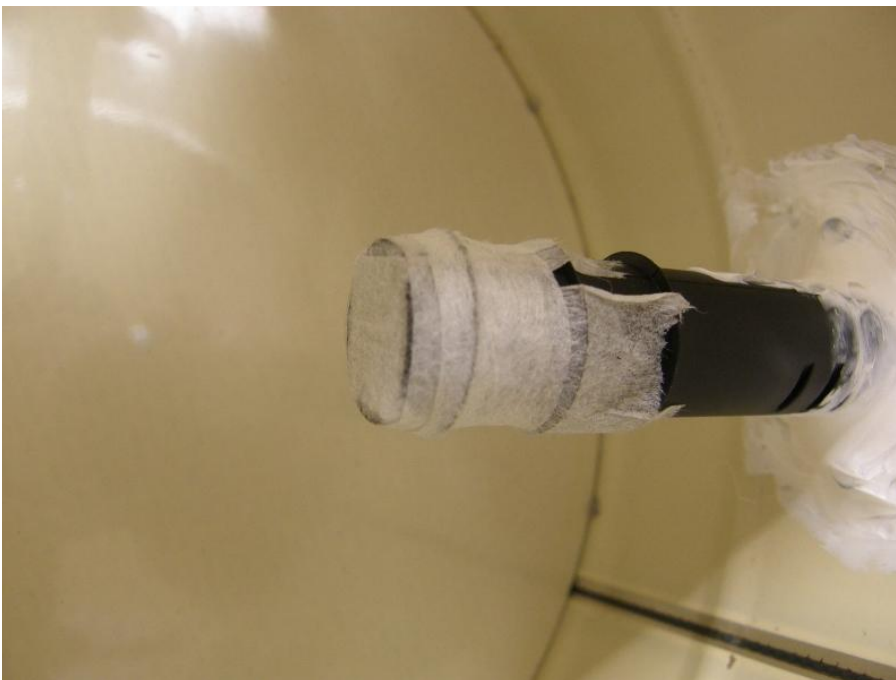
Figur 3.2 Form för prov där mätning av relativ fuktighet genomförs med flera metoder, prov 4-6 enligt tabell 6.14. HumiGuard sensor monteras i vitt plaströr medan Vaisala monteras i svarta. Två av de svarta rören var försedda med semipermeabel tejp medan resterande två med skruv, se figur 3.4, vilken demonterades under härddningen.
