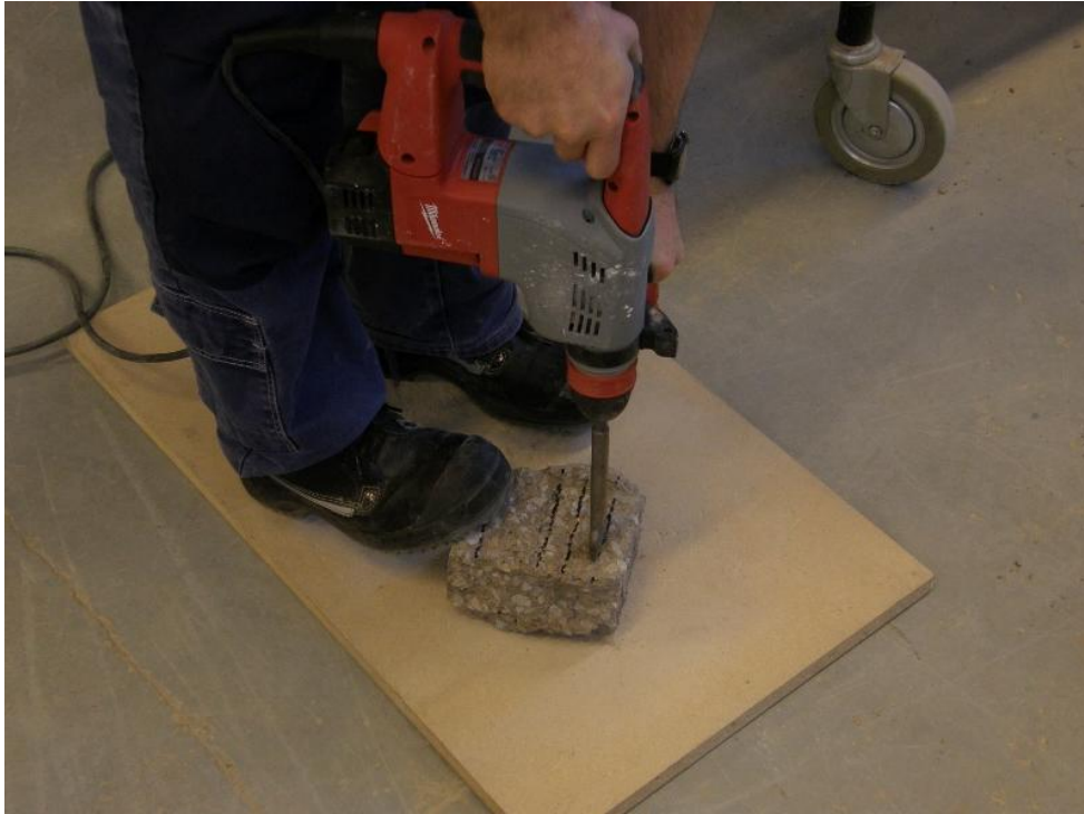
Figur 2.7 Från rätblock enligt figur 2.6 tas prov ut på tre djup, 0-20 mm, 50-70 mm och 130-150 mm, med hjälp av bilningsmaskin.
