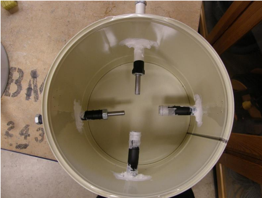
Figur 3.2 Form för prov där mätning av relativ fuktighet genomförs med flera metoder, prov 4-6 enligt tabell 6.14. HumiGuard sensor monteras i vitt plaströr medan Vaisala monteras i svarta. Två av de svarta rören var försedda med semipermeabel tejp medan resterande två med skruv, se figur 3.4, vilken demonterades under härddningen.
