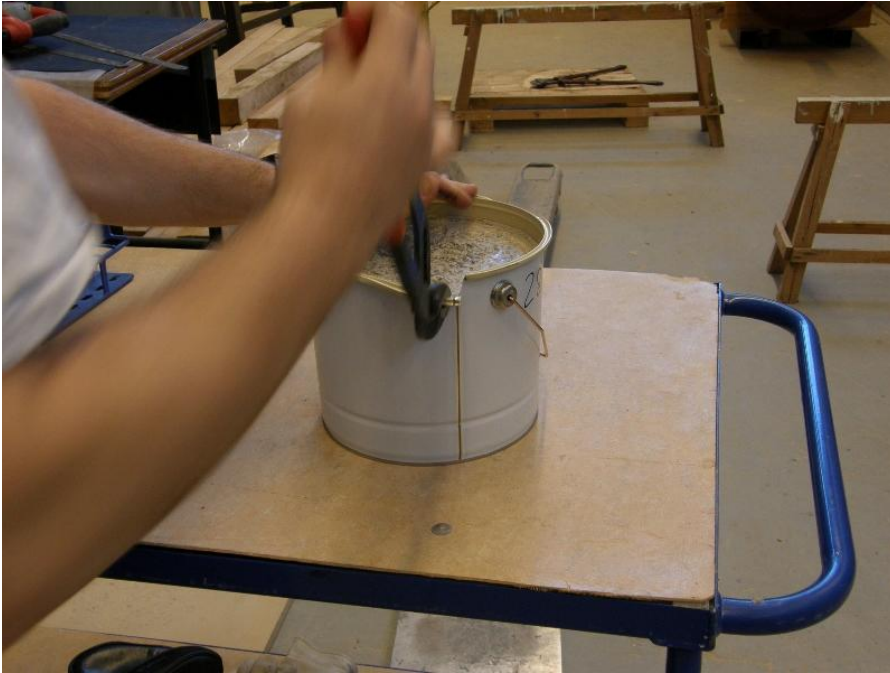
Figur 2.3 Demontering av prov från form sker genom att mantel delas vid befintlig skarv med hjälp av tång.
