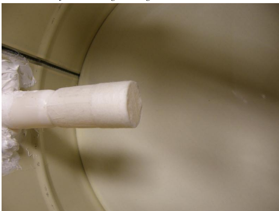
Figur 2.2 Ingjutet plaströr, sett från insida gjutform, för montering av HumiGuard RF-sensor och försett med semipermeabel tejp som hinder mot färsk betong.
