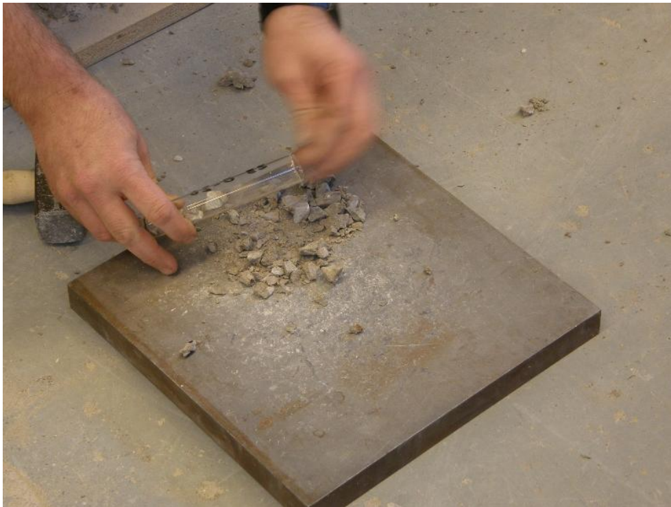
Figur 2.8 Uttagna provbitar från respektive djup placeras i glaströr som förseglas med gummikork i väntan på RF-mätning.
