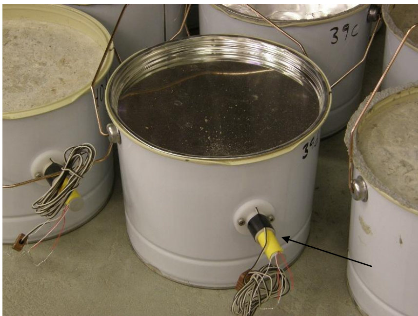
Figur 2.1 Behållare (5 liter) och lock av plåt som form för prov. Ingjutet plaströr (se pil) för montering av RF-givare, HumiGuard.
