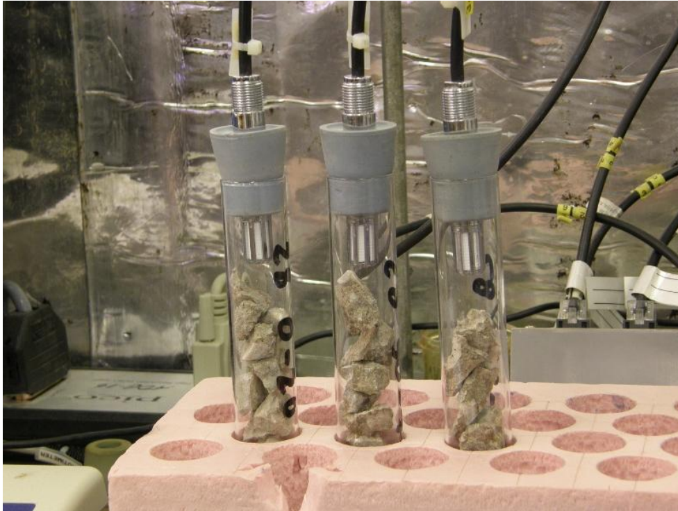
Figur 2.9 Mätning av relativ fuktighet på uttagna prov placerade i provrör med sensor av fabrikat Vaisala.
